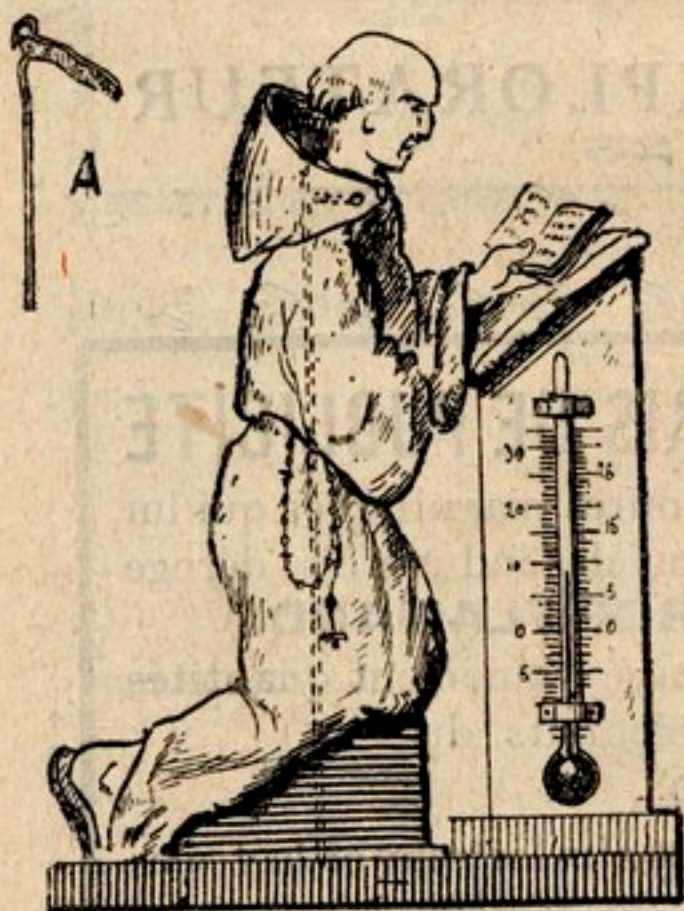
FIG. 1. — Hygroscope à boyau : A attache de la corde du boyau.
